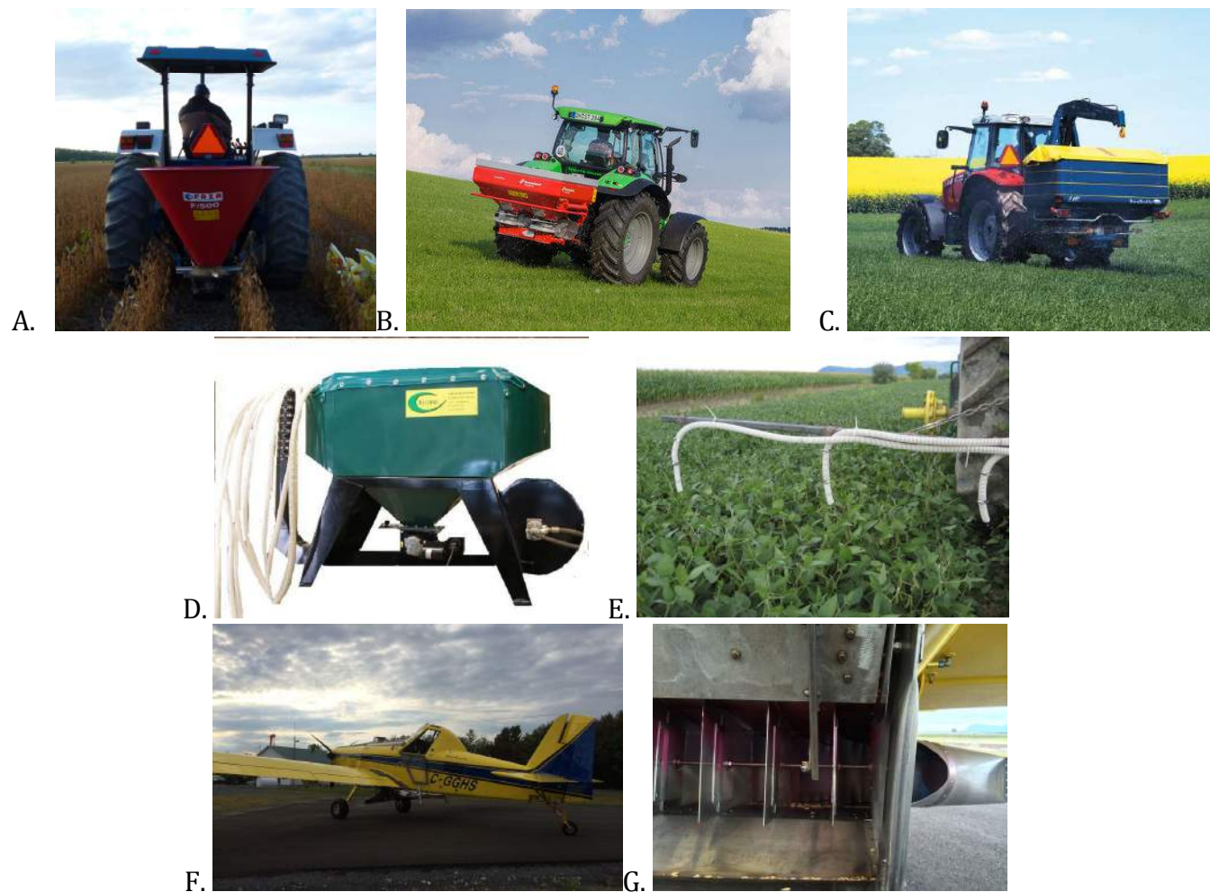
Figure 1 : modèles d'équipement utilisés pour le semis à la volée : A. épandeur d'engrais à la volée en entonnoir ; B. épandeur d'engrais à la volée Kverneland (source : kverneland.com) ; C. épandeur d'engrais à la volée Bogballe (source : agriavis.com) ; D et E. semoir pneumatique à descente par tuyaux Delimbe (source : Delimbe.fr) ; F et G. avion
